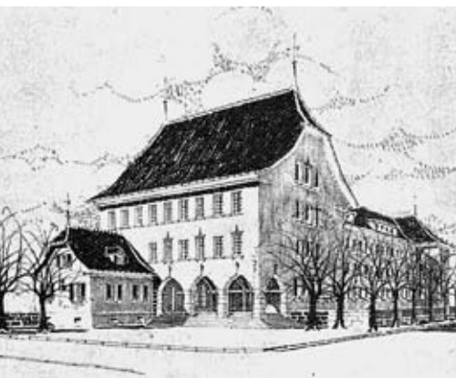
Abb. 8a+8b: Zwei weitere Entwürfe für das Thuner Progymnasium verdeutlichen das enorme Spannungsfeld zwischen Heimatstil und Moderne um 1925: Links der im Wettbewerb zweitplatzierte Entwurf von Lori & Dubois aus Biel mit hohem Gerschilddach, rechts der progressive Gegenentwurf des Holländers Mart Stam. In enger Anlehnung an das damals entstehende Dessauer Bauhaus arbeitet Stam mit aufgeständerten Kuben und deren Verschachtelung, gelangt zu zahlreichen besonnten und beschatteten Freiluftflächen und maximiert den Lichteinfall durch grosse Fensterbänder (Schweizerische Bauzeitung 87 (1926), S. 35; Oechslin, Mart Stam (wie Anm. 11), S. 67).
