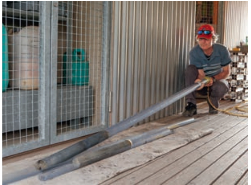
Abb. 4: Daniel Steffen beim Ausstossen eines Bohrkerns mit Pressluft.
