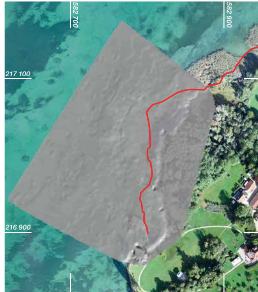
Abb. 3: Sutz-Lattrigen, Rütte. Oberflächenmodell des Seegrunds im Frühjahr 2014, projiziert auf das gleichzeitig erstellte Luftbild. Die Uferlinie hat sich gegenüber dem Stand von 1947 (rot) stark zurückgezogen. M. 1:5000.
