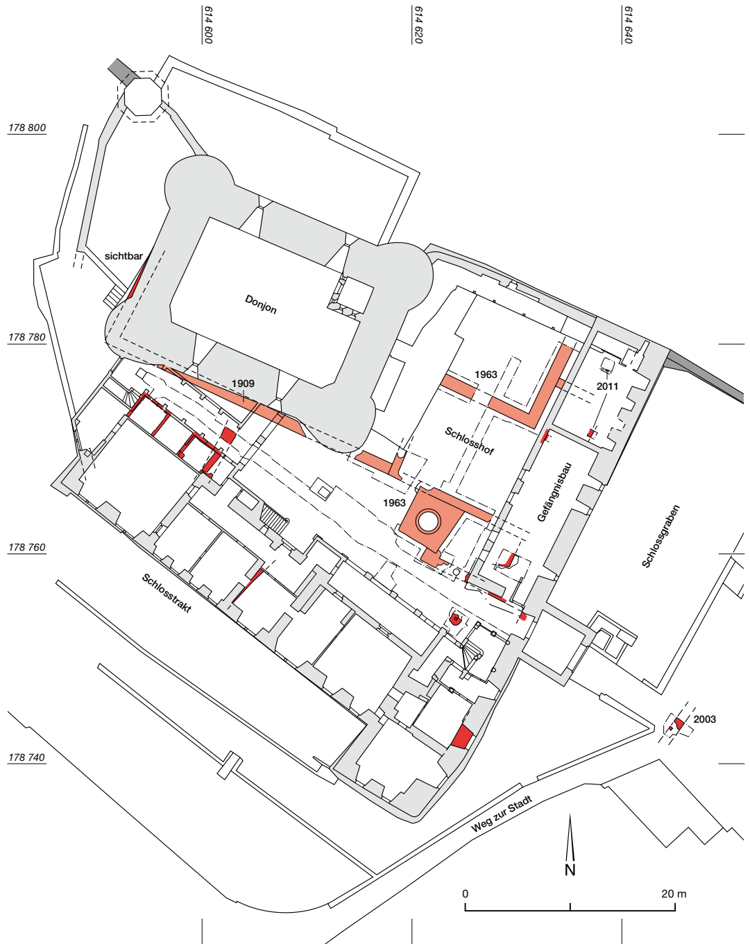
Abb. 2: Thun, Schloss. Übersichts- und Phasenplan zum Baubestand von Schloss Thun mit Eintrag der aktuellen Ergebnisse und den Resultaten der Altgrabungen von 1909 und 1963. M. 1:500.
