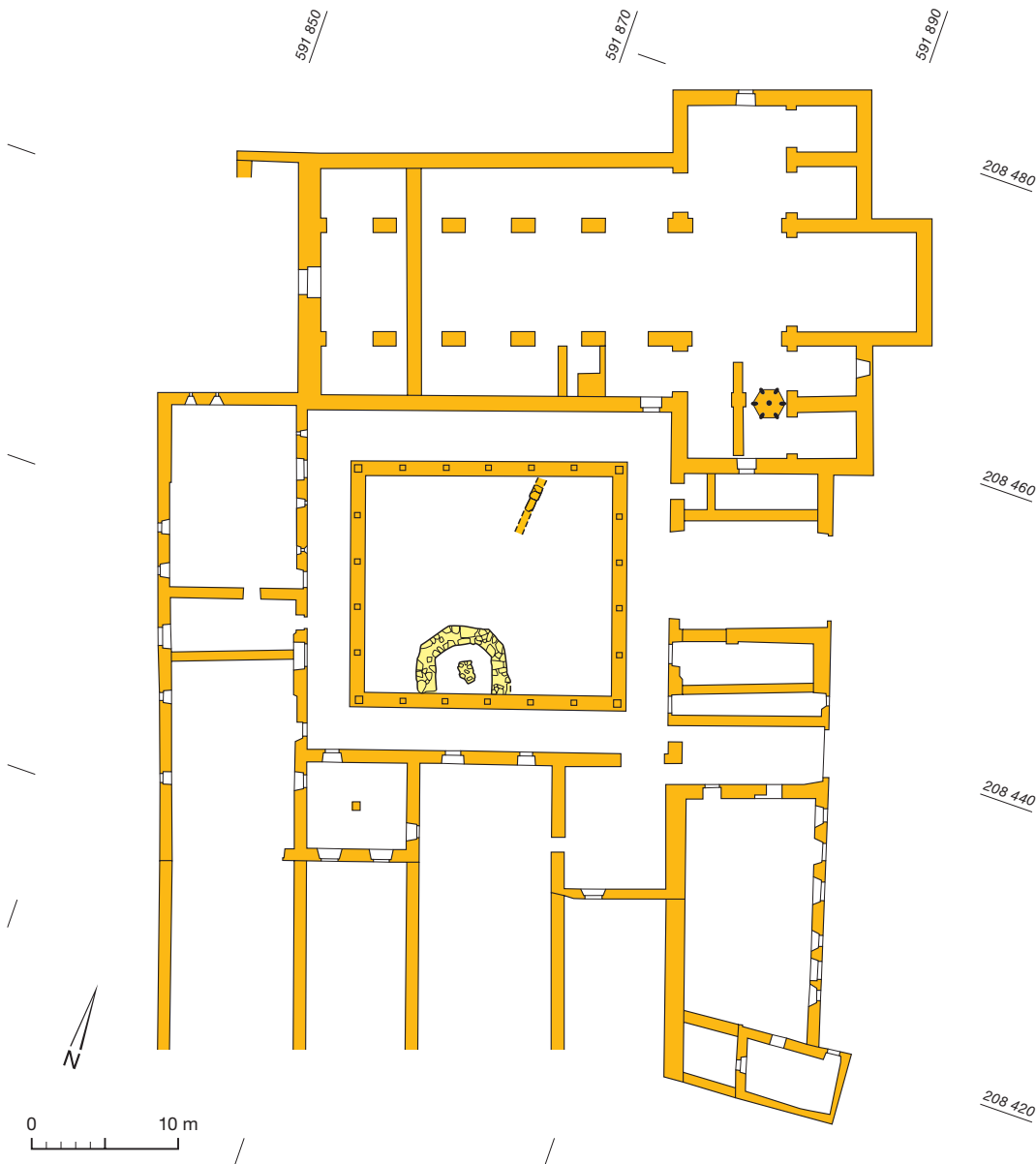
Abb. 2: Seedorf, Kloster Frienisberg. Übersichtsplan des Klosterhofes mit den Fundamenten des Brunnenhauses und des Steinkanals. Als Grundlage diente der Grundrissplan beziehungsweise die Rekonstruktion des Klosters nach dem Umbau 1973 bis 1976. M. 1:500.
