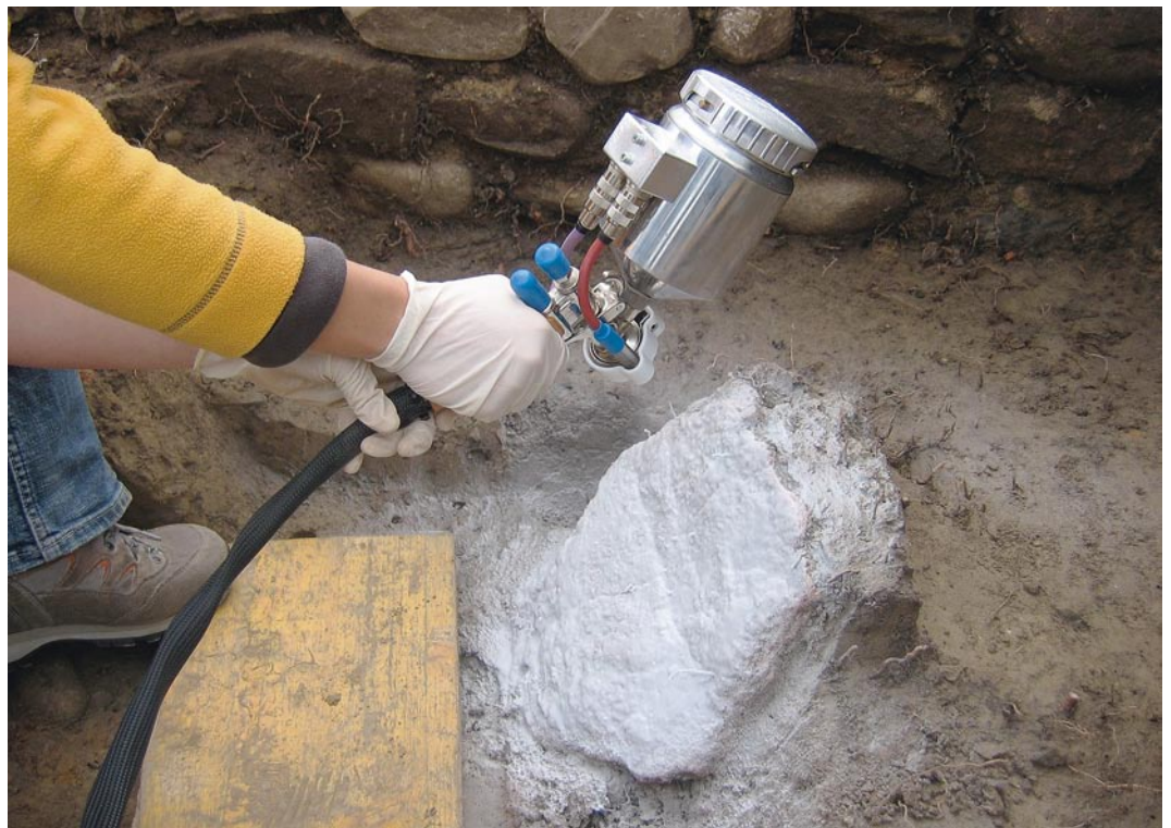
Abb. 1: Anwendung der CDAN-Schmelze mit der Sprühpistole auf Fragmente römischen Terrazzoverputzes in Jegenstorf, Solothurnstrasse.
