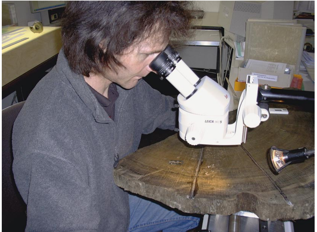
Abb. 4: Dendrochronologisches Labor des Archäologischen Dienstes (ADB), Von Rütte Gut, Sutz-Lattrigen. Daniel Steffen beim Messen der Jahrringbreiten an einer der Proben von Utzenstorf.
